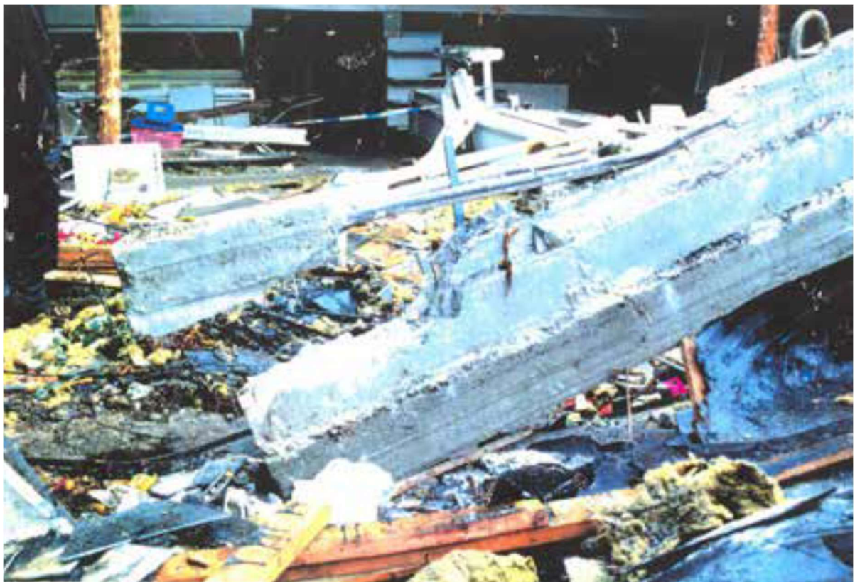
Joonis 2. Raudbetoontala purunemine toe piirkonnas praktiliselt olematu põiksarrustuse tõttu
